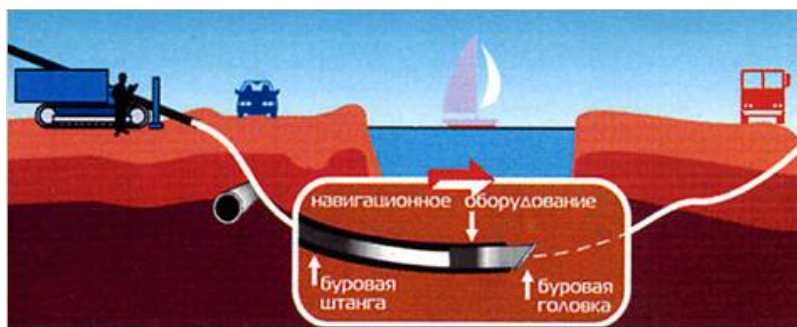
Рисунок 10.2. Бурение пилотной скважины (1 этап)
